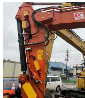
後付けICTシステムでICT建機化
