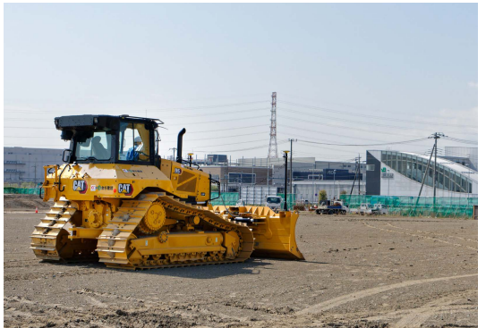
ニュータウン開発の盛土工事に活躍する次世代型D5ブルドーザ。右奥に見えるのがJR武蔵野線吉川美南駅。
