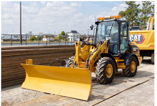
豪雪時の緊急出動に備えて資材センターで出番を待つ907Mホイールローダ(道路維持作業車)。
